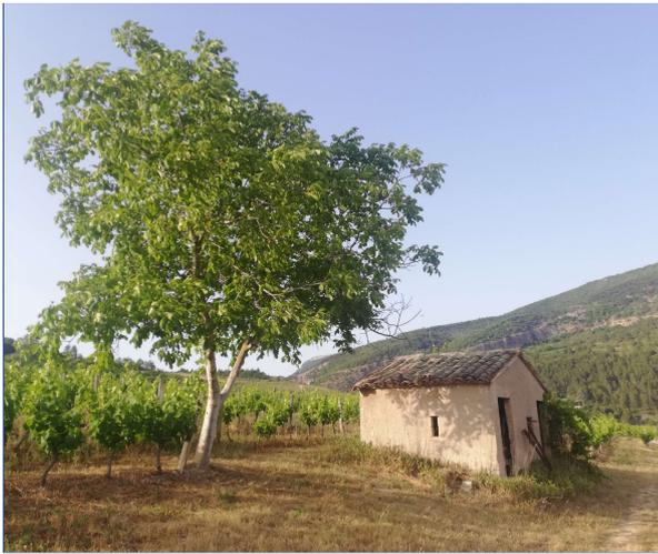
Les cabanons sont de petites constructions, isolées en bordure de vigne ou au centre de la parcelle, construits à partir de la seconde moitié du XIX siècle pour usage viticole. C'est une construction vernaculaire d'un niveau, le plus souvent, d'une surface d'emprise au sol d'environ 10m<sup>2</sup> dont l'archétype est une maçonnerie de pierres jointoyées, une toiture 2 pentes couverte de tuile canal, une porte en sapin, une fenêtre.
